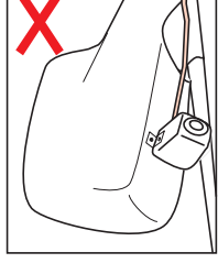
カメラの配線露出
